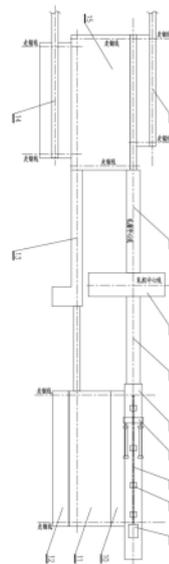
1. 一种能实现多种轧制模式的钢管工艺设备,其特征在于:包括依次连接的轧机后台、轧管机、轧机前台一段与轧机前台二段;
