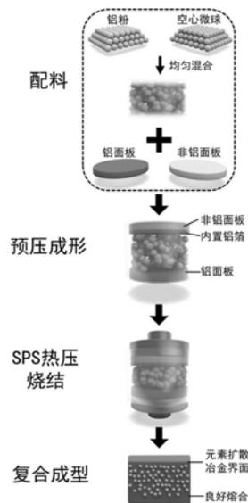
1. 一种铝基多孔复合夹芯结构的制备方法,其特征在于,包括:将自下而上叠加的下层金属面板、铝基多孔复合原料和上层金属面板进行预压成形得到待烧结坯体,将所述待烧结坯体进行等离子热压烧结。
